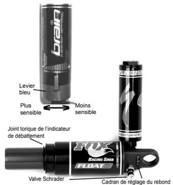
Le manchon d'air peut être révisé comme celui des amortisseurs arrière FLOAT (voir page 43 et 44). Le support doit être retiré avant d'enlever le manchon d'air. Une clé à fourche de 22 mm est nécessaire pour retirer le support. Serrez à un couple entre 19,5 et 22,5 Nm lorsque vous le réinstallez. Une douille pied de biche de 22 mm est nécessaire pour remettre le support en place.
