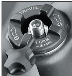
**Abb. 2:** TALAS Einstellknopf an der oberen Luftabdeckkappe und Schraderventil
