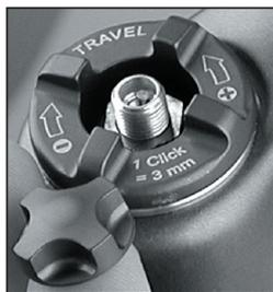
Fig. 2 TALAS Air Top Cap Knob & Schrader Valve
