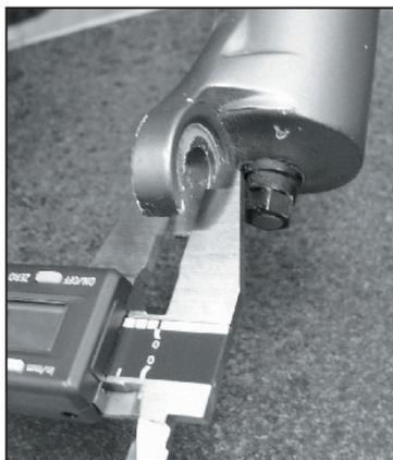
Fig. 2 Misurazione del forcellino
