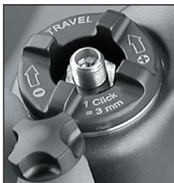
Fig. 2 Manopola tappo superiore dell'aria TALAS & valvola Schrader
