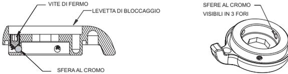
c) Su i modelli RLC, sollevare la manopola di compressione a bassa velocità. Guardare il fondo della manopola a bassa velocità. La sfera di fermo al cromo del diametro di 3 mm potrebbe essere bloccata dal grasso sul fondo della manopola. Se ciò avviene, lubrificare la sfera di fermo e rimetterla nel foro nella cavità del tappo superiore dello smorzatore. Premendo sulla sfera di fermo con un piccolo cacciavite si dovrebbe avvertire il ritorno.
