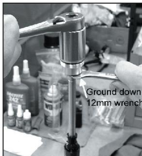
Fase 9 - Svitare il tappo superiore dello smorzatore dal tubo superiore e comprimere verso l'alto il braccio inferiore della forcella. Versare nel tubo superiore DESTRO 155 cc di liquido per sospensioni FOX (7.5 wt). Sulle forcelle Vanilla, tirare leggermente di lato lo smorzatore per versare l'olio oltre la molla.
