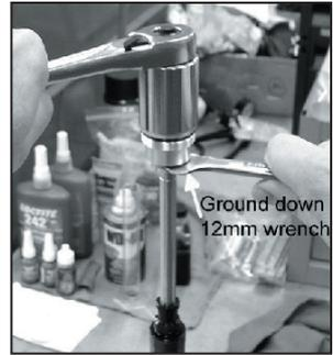
Schritt 9: Lösen Sie die Dämpfer-Abdeckkappe des oberen Rohrs, und drücken Sie das untere Gabelrohr nach oben. Füllen Sie in das **rechte** obere Rohr 155 ml FOX Suspension Fluid (7,5 WT) ein. Drücken Sie bei Vanilla-Gabeln den Dämpfer leicht zur Seite, damit das Öl hinter die Feder gelangen kann.
