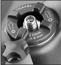
Fig. 2 Bouton du capuchon de protection de valve Schrader du modèle TALAS
