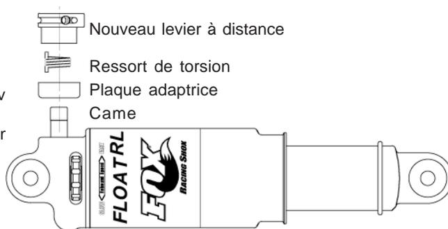
Fig. 1 Plaque adaptrice, ressort et installation de levier
