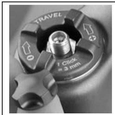
Fig. 2 TALAS-LuftOberseiten-KappenDrehknopf U. Ventil Schradler
