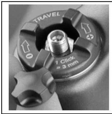
Fig. 2 TALAS-LuftOberseiten-KappenDrehknopf U. Ventil Schradler
