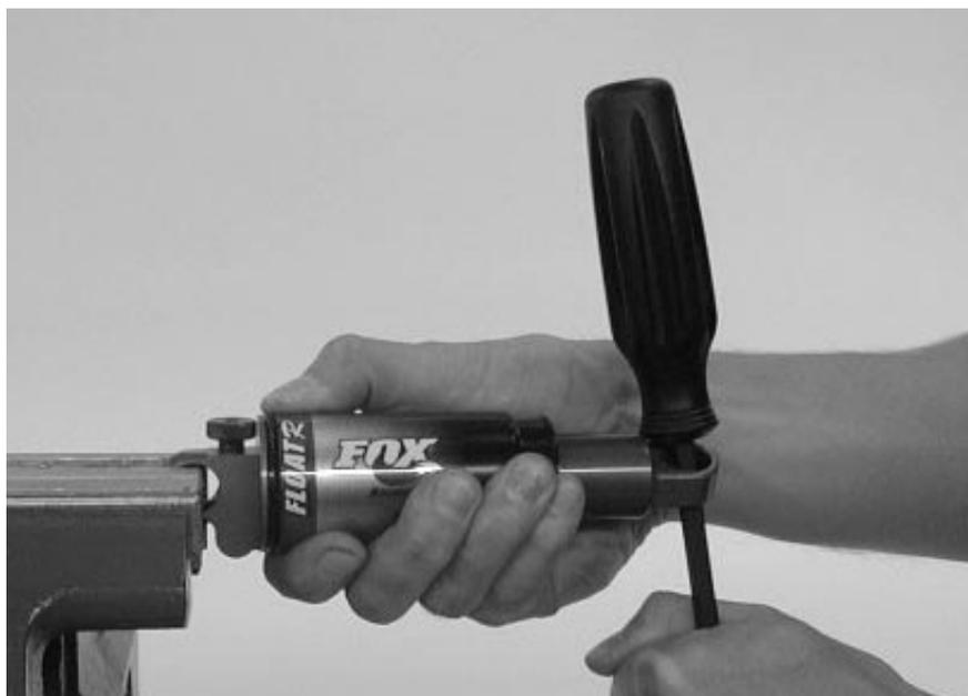
**Abb. B.** Ausbau der Luft-Hülse
