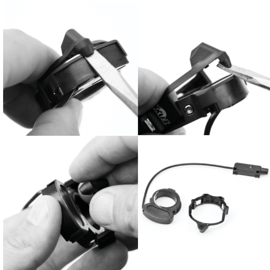
図 15：スイッチの分解方法
