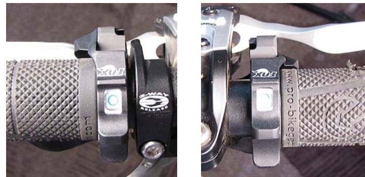
図4：左手側・右手側のスイッチの取り付け状況
